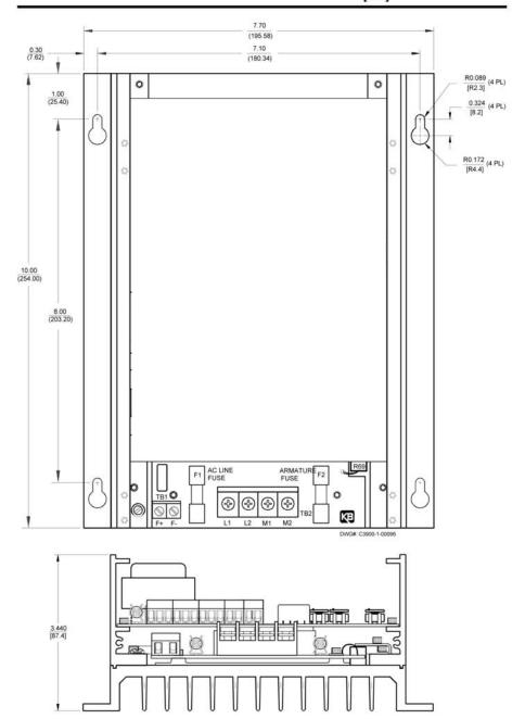
NOTE: CONTROL SHOWN ABOVE IS MODEL KBRG-225D. HEIGHT OF MODEL KBRG-240D IS 2.57" (65 mm).
